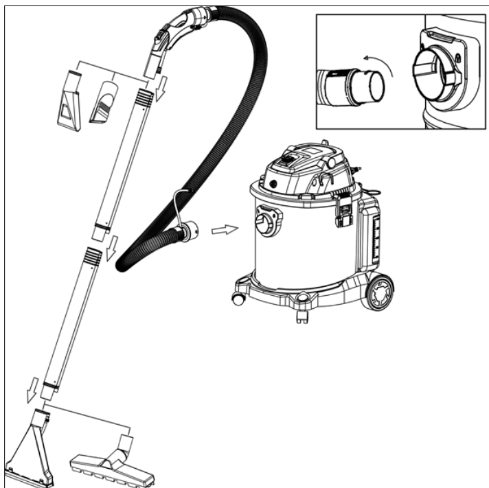
Рис. 8 Подсоединение гофрированного всасывающего шланга
